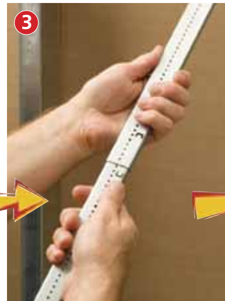
3. Wsuń jedno ramię w drugie, aż do usłyszenia kliknięcia.
